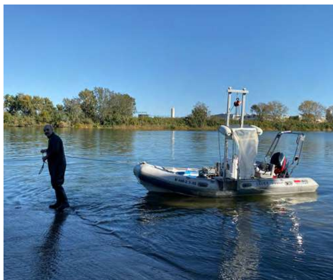
Embarcación con estructura para izado de la red y Arrastre de la red de muestreo superficial.
